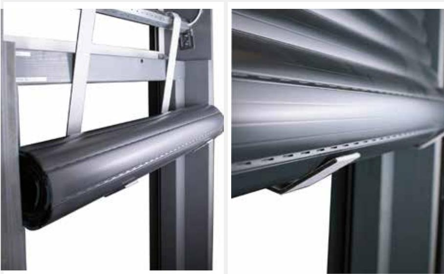
Mit den Panzereinzugshilfen haben Sie immer eine Hand frei. Nutzen Sie die kleinen Helfer in Ihrem Arbeitsalltag und erleichtern Sie sich den Einbau von Rollläden. Sowohl für den Einbau von innen als auch von außen (raumseitgeschlossen) erhältlich.
