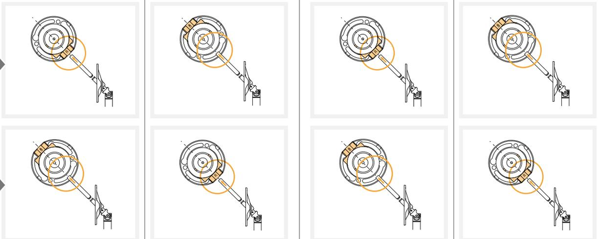
Einbauweise in Abhängigkeit der Kurbelrichtung - Aufwärtsbewegung
