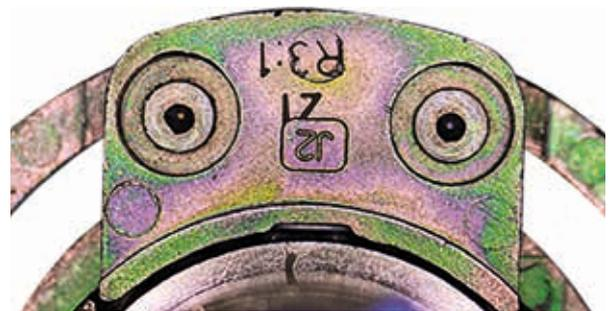
Um die **Getriebeausführung** auf den ersten Blick bestimmen zu können stellen Sie das Getriebe mit der **Montagseite** senkrecht auf Ihre **Handfläche**. Zeigen die **Kupplungselemente** nach links handelt es sich um eine linke Getriebeausführung. Zeigen diese nach rechts um eine rechte Getriebeausführung.
