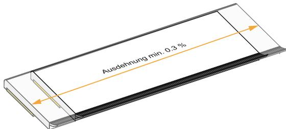
Beachten Sie, dass die Profile genügend Möglichkeit zur Längenausdehnung haben, da es sonst zu Spannungen und einer daraus resultierenden Ablösung vom Baukörper kommen kann.
